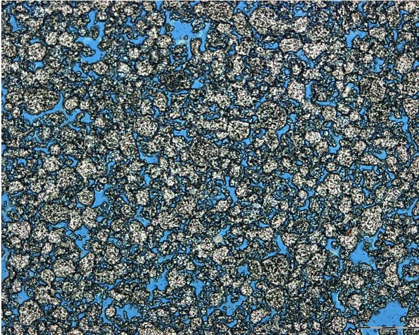
Abb. 3: Lichtmikroskopische Aufnahme von Korund (Länge des Messbalkens (unten rechts im Bild): 200 µm)
