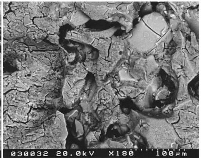
Abb. 39: Ausschnitt aus Abb. 37, gleiche Probenstelle wie in Abb. 38, aber nach Trocknung, von den ehemaligen Kristallen ist nichts mehr übrig geblieben, oben rechts im Bild ist ein gebrochenes Glasteilchen freigelegt. Auch sonst schimmern Glasoberflächen durch, die vorher mit Lösung überzogen waren. Auch hier wird die Volumenverringerung der gesamten Salzmasse deutlich.
