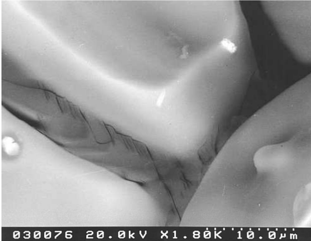
Trocknungsrisse entlang der Korngrenzen des Magnesiumsulfat-Hochhydrats im Porenraum einer Glasfritte (kryo-mikroskopische REM-Aufnahme)
